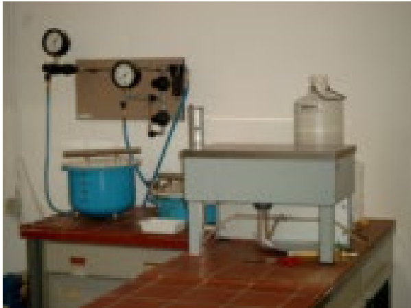
Abbildung 3: Apparatur zur Bestimmung der pF/WG-Beziehung
