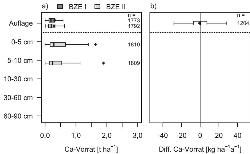
**Abb. I-4-33: Calciumvorräte im Auflagehumus und im Mineralboden zum Zeitpunkt der BZE I und BZE II (a, gesamte Stichprobe inkl. Moor- und organisch geprägte Standorte) sowie Veränderungen der Calciumvorräte von der BZE I zur BZE II (b, gepaarte Stichprobe ohne Moor- und organisch geprägte Standorte).**
